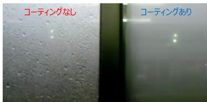
節電ガラスコート55塗布・未塗布の結露状態の違い
